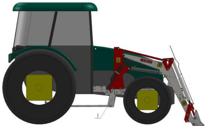
Рис. 7. Монтаж рамы на тракторе
