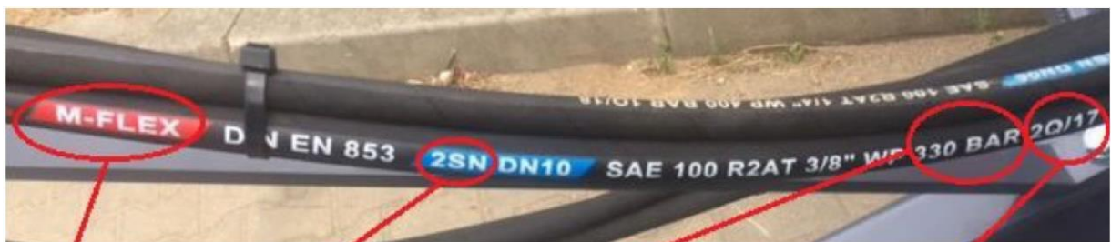
Производитель Тип шланга Максимальное давление Дата изготовления (в данном случае - 2 квартал 2017 года)
