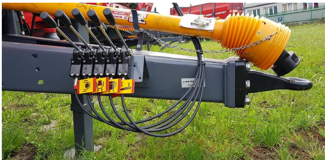
Рисунок 22. Маркировка рычагов управления навозоразбрасывателя (управление навозоразбрасывателем является опцией)
