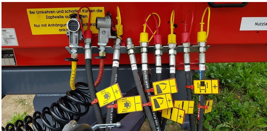
Рисунок 21. Маркировка разъемов на гидравлических шлангах для облегчения подсоединения шланга к трактору
